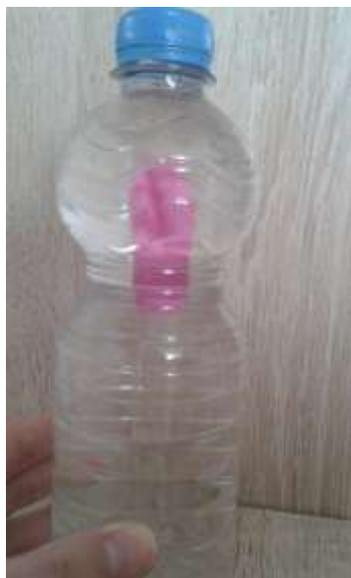
Wenn der Bau gelungen ist, so sinkt der Taucher beim Drücken der Wasserflasche. Er steigt wieder, wenn der Druck von der Flasche genommen wird. Aber woran liegt das?
